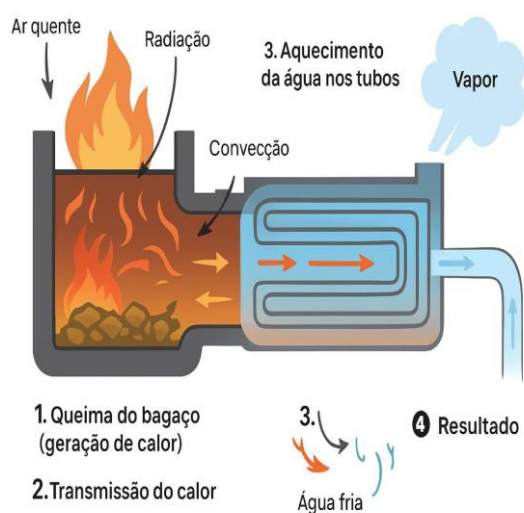
Figura 1: Representação da queima do bagaço e geração de vapor, a imagem tirada da Instrução de Trabalho da Usina Cox Abengoa.
