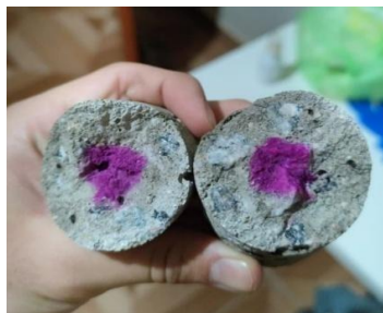
FIGURA 2: Aplicação de fenolftaleína no corpo de prova de concreto. (ABNT NBR 5738)
