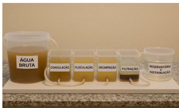
FIGURA 1. Representação de uma ETA em bancada.
