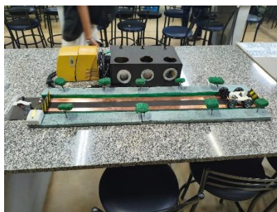
FIGURA 2. Sistema completo montado (pista, carrinho e semáforo).
