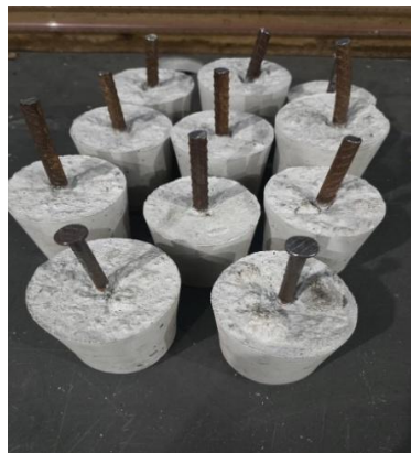
Figura 2: Amostras em processo de corrosão
