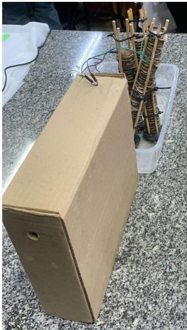
FIGURA 1. Experimento de pilha voltaica finalizado e exposto em evento acadêmico, demonstrando as ligações elétricas que levam ao led inserido em um caixa de papelão, com uma abertura para se ter a visualização do funcionamento da lâmpada. Fonte: Próprio Autor, 2025.
