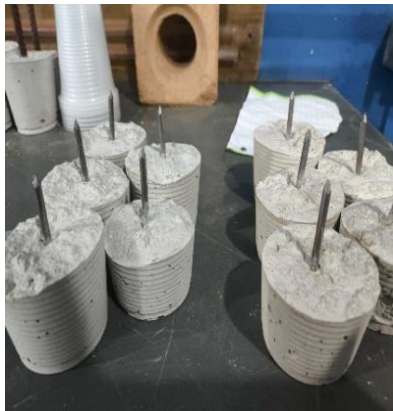
Figura 1: Amostras não corroídas
